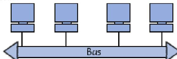
Cette topologie a pour avantage d'être facile à mettre en oeuvre et de posséder un fonctionnement simple. En revanche, elle est extrêmement vulnérable étant donné que si l'une des connexions est défectueuse, l'ensemble du réseau en est affecté.
