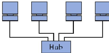
Contrairement aux réseaux construits sur une topologie en bus, les réseaux suivant une topologie en étoile sont beaucoup moins vulnérables car une des connexions peut être débranchée sans paralyser le reste du réseau. Le point névralgique de ce réseau est le concentrateur, car sans lui plus aucune communication entre les ordinateurs du réseau n'est possible.
