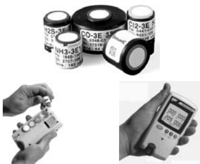
Figure 20.8 Capteurs ampérométriques pour gas (Amperometric Gas Sensors). Assortiment de capteurs de la société ATMI Sensoric Div. (Ger.). Modèle GasAlertMax3-DL de la société BW Technologies (Can.); La photo centrale montre le compartiment où sont rangés les 4 détecteurs spécifiques aux 4 gaz détectables simultanément. Après avoir franchi une barrière de diffusion spécifique afin de ne pas saturer le capteur, le gaz est oxydé (CO, H 2 S, NO, H 2 , HCN) ou réduit (Cl 2 , NO 2 ) en présence de l'électrolyte au contact d'une électrode dite de travail de grande surface.
