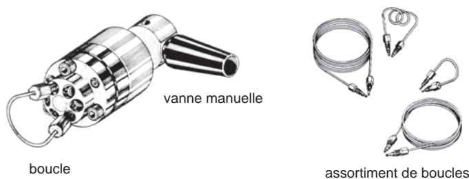
Figure 2.4 Vanne d'injection pour CLHP et boucles assorties.
