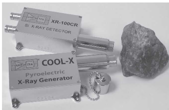
Figure 12.4 Générateur et détecteur de rayons X miniaturisés.
