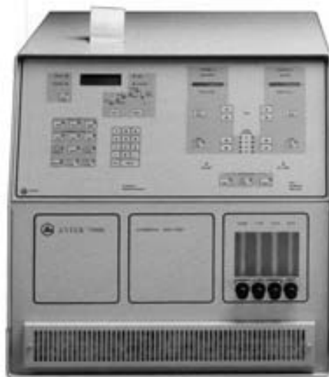
Figure 11.17 Analyseur de soufre et d'azote. Modèle 7 000 NS reproduit avec l'autorisation de la société Antek. Cet appareil réunit deux techniques de luminescence : l'azote est dosé par chimiluminescence (voir diagramme, figure. 11.13) et le soufre par fluorescence de \text{SO}_2 (excitation UV).
