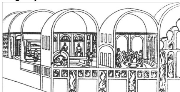
Source: A. Pelletier, 1982 Système d'hypocauste dans les thermes
