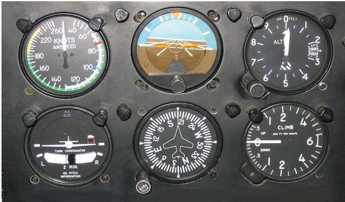
Photo d'une planche de bord classique (analogique) avec la configuration minimale en T
