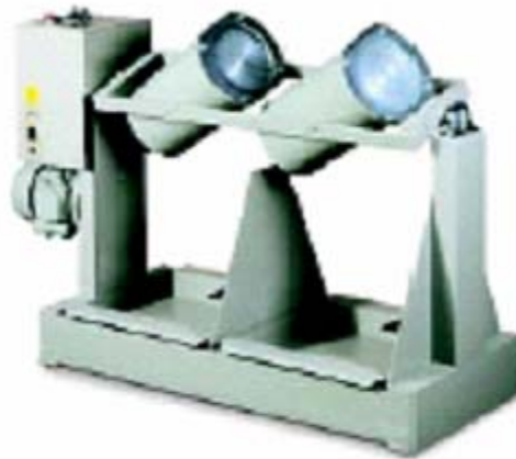
figure 1 appareil de l'essai Deval
