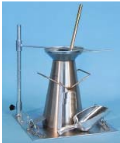
Figure 4 Appareillage de cône d'Abrahms
