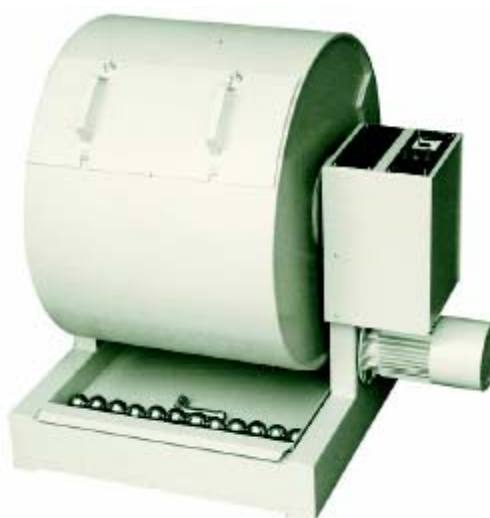
figure 2 appareil de l'essai Los Angeles
