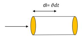
Soit tube de courant formée de filets de fluides, la vitesse V est constante en tout point, pendant l'intervalle de temps dt, le liquide se déplace de  $\overline{dl}=\overline{V}dt$ , passant de S à S c-a-d qu'il est passé à travers S un volume de liquide égal à dV=Svdt et un débit volumique Q égal par définition à  $Q=\frac{dv}{dt}=Sv$   $sv\to Q=Sv$
