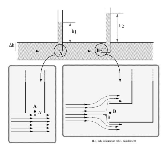
On considère un liquide en mouvement dans une conduite horizontale, plaçons un tube ouvert dur l'extrémité est perpendiculaire à la direction d'écoulement.
