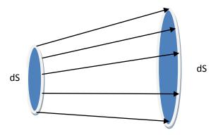
Un Filet courant ou filet fluide est tube de courant de section infiniment petite. La juxtaposition d'une infinité de Filets Fluide ou de plusieurs tubes de courant donne une veine Fluide.
