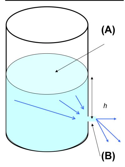
Considérons un bassin muni d'un orifice, l'application de l'équation de Berouilli aux point A et B, donne :
