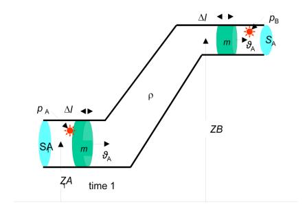
Considérons un tube de courant délimité par deux sections  $S_A$  et  $S_B$ , telles que les vitesses  $\overrightarrow{\vartheta}_A$  et  $\overrightarrow{\vartheta}_B$  et les pressions  $P_A$  et  $P_B$  dans ces sections soient constantes.
