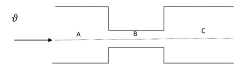
L'expérience montre que dans les parties rétrécies d'un tuyau horizontal, la vitesse d'un liquide augmente c'est le phénomène de venturi.
