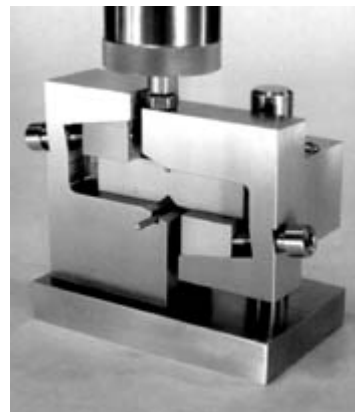
Figure 32 : Essai d'Iosipescu (composites, bois...)
