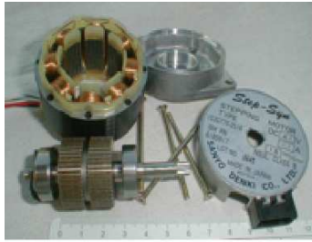
Moteur pas à pas se comportant comme un circuit RL
